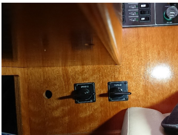
De to hovedafbrydere sidder under kortbordet (her vist i stilling OFF)
