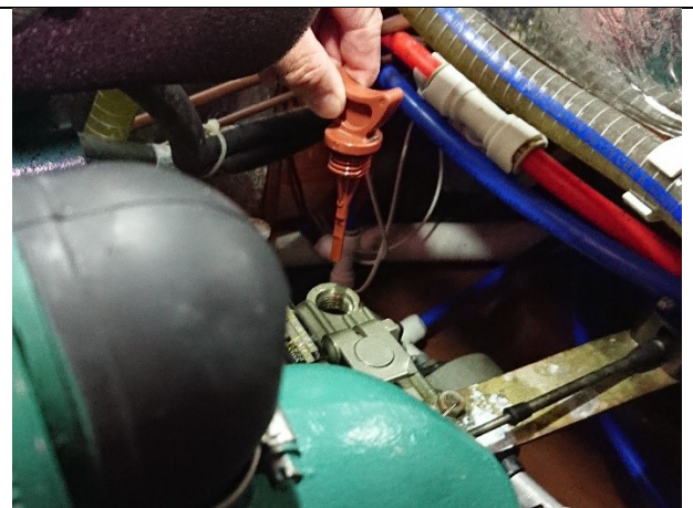
S-drev oliepinde skal ikke skrues ved måling af oliestand, men aftørres inden måling
